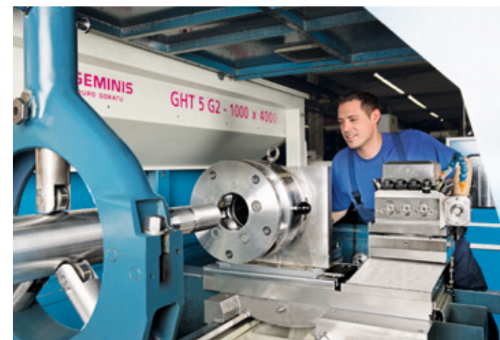
Gewinderollen einer Kolbenstange: Präzision bei der Kaltverformung für 170 Tonnen Belastung im späteren Einsatz. Foto: Neuman & Esser
